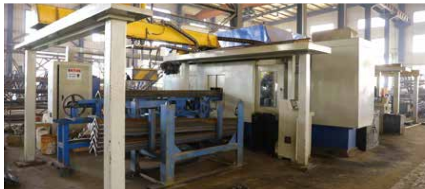
片式标准节 智能加工中心 Panel section intelligent machining center
