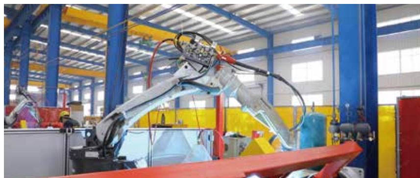
片式标准节 全自动焊接机器人 Panel section auto welding robot
