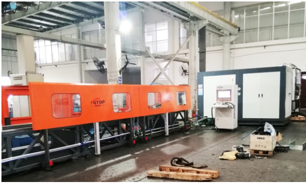
湖南特力液压有限公司（中联）-油缸出厂测试台 Cylinder factory test bench
