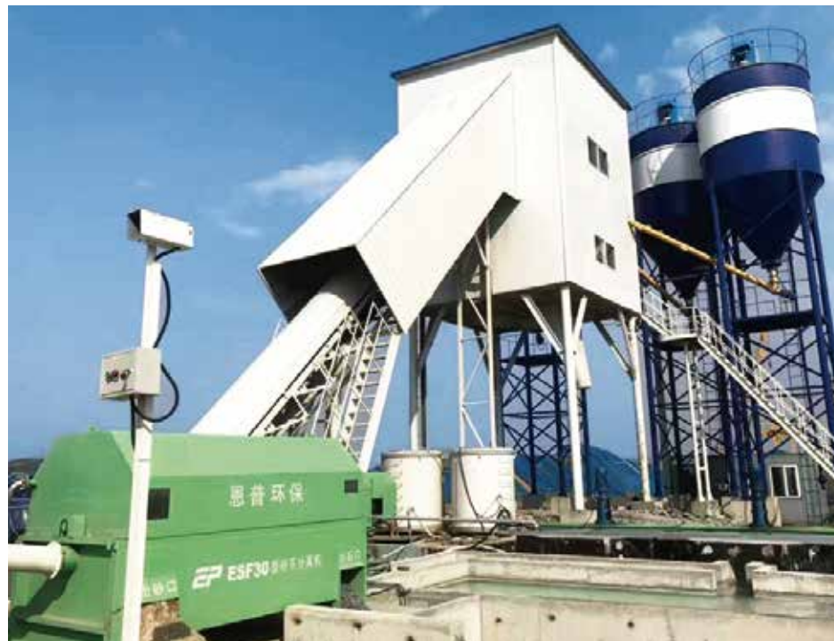
ESF30型砂石分离机 ESF30 Concrete reclaimer
