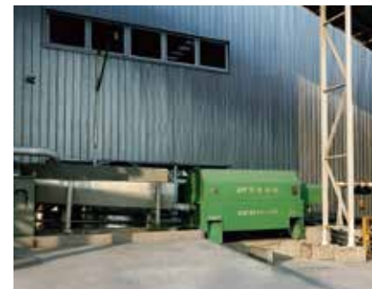
ESF30型砂石分离机 ESF30 Concrete reclaimer
