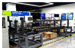
钢丝绳无损检测实验
