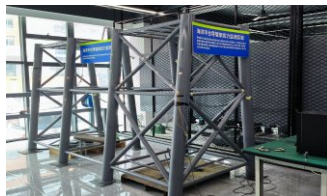
海洋平台导管架(光纤)应力监测
