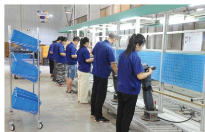
方向机总成装配流水线
