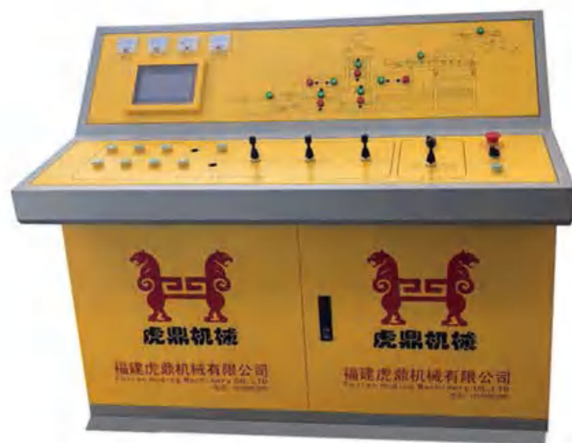
电控箱 plc control system
