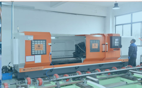
数控磨床(精密磨削加工)
