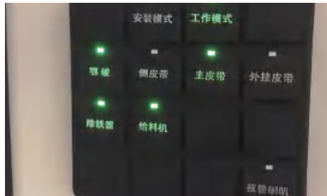
采用传感器监控设备运行状态，报警信号可视
