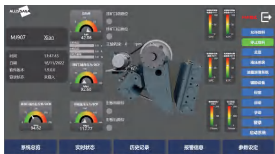
JCIS --- 颚式破碎机智能控制系统
