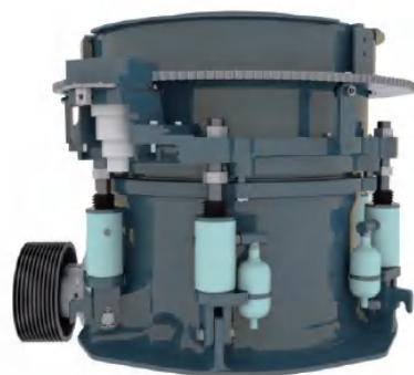
液压缸布置在机身四周，有效降低了机体高度，同等产量下降低了厂房高度的需求
