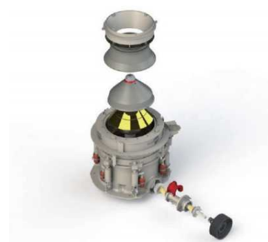
检修可通过上部拆卸完成，液压马达能使定锥全部转出调整环，以便更换衬板，方便快捷
