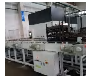
先进的热处理设备 - 全自动渗碳设备
