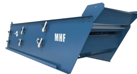
整块钢板折边，高强度螺栓连接， 筛体无焊接
