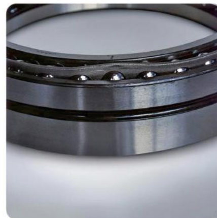
角接触球轴承的保持架。 钢板冲压保持架的变形。 原因是使用不当产生的冲击载荷。 Cage for angular contact ball bearings. Deformation of steel plate stamping cage. The reason is the impact load produced by improper use.
