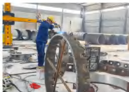
旋挖护筒生产 full casing
