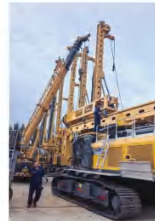
徐工XR240E翻新再制造设备技改10T液压打桩锤案例
