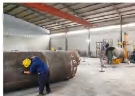
旋挖护筒生产 full casing
