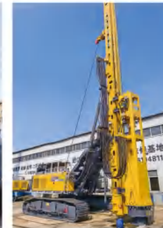
徐工XR240E翻新再制造设备技改10T液压打桩锤案例
