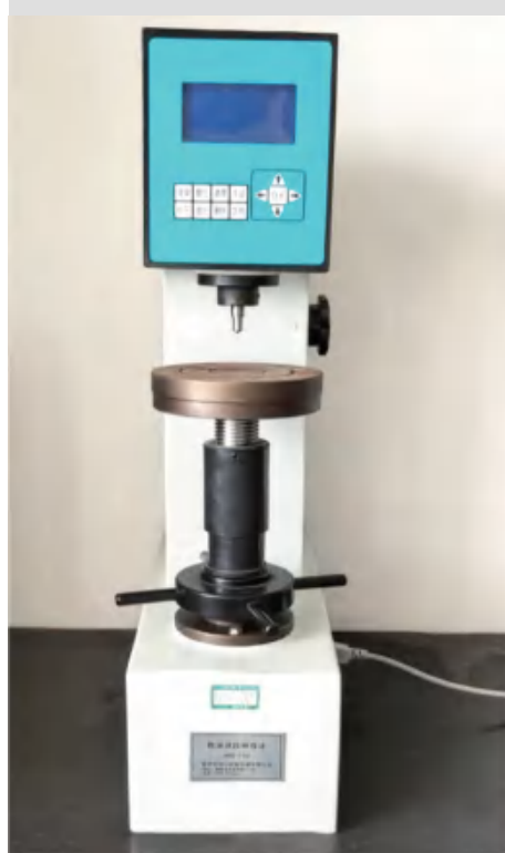
洛氏硬度计 Rockwell Hardness Tester
