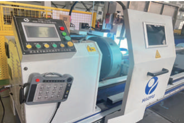
全自动化电焊机 加工行程范围：Φ400—L3000
