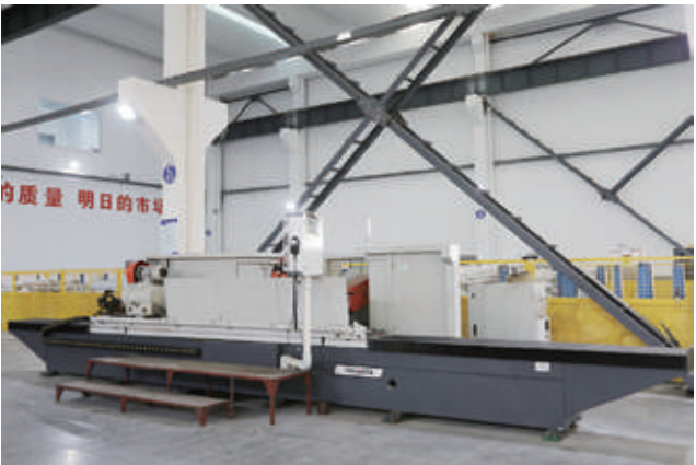
数控外圆磨床 加工行程范围：Φ500—L3000
