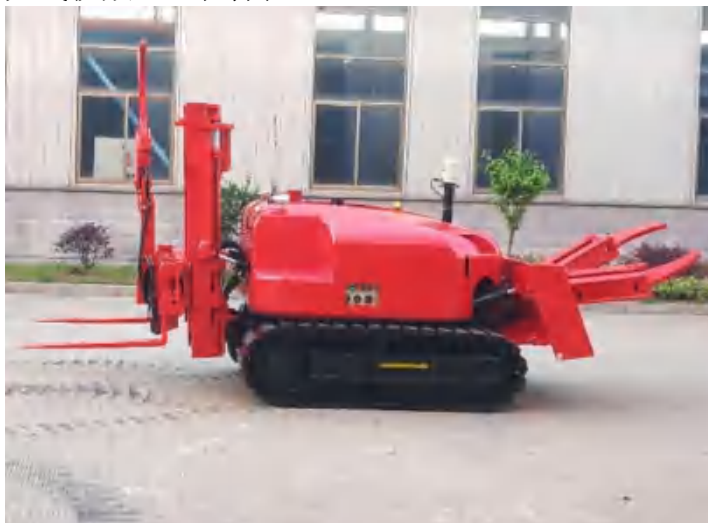
应用单位：重庆消防武警部队：应用于隧道内障碍物的清除，具有叉运、牵引、剪切、推铲、远程遥控、无线视频等功能。
