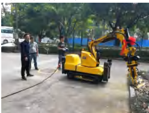
应用单位：中国核动力研究院：核废料抓取、装箱，能进入狭窄空间、防核辐照、无线视频、远程操控。
