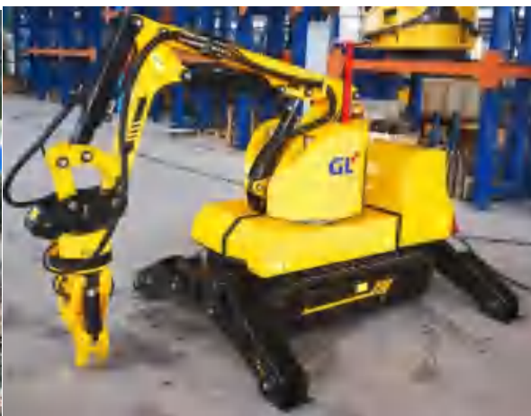
应用单位：中国核动力研究院：核废料抓取、装箱，能进入狭窄空间、防核辐照、无线视频、远程操控。
