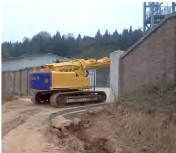
应用单位：中国工程物理研究院，高危物品搬运，可在 6 米外抓取 500Kg 重物，遥控距离 2km 以上。
