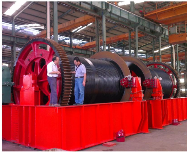
QPQ2×3200KN固定卷扬式启闭机正在进行厂内组装
