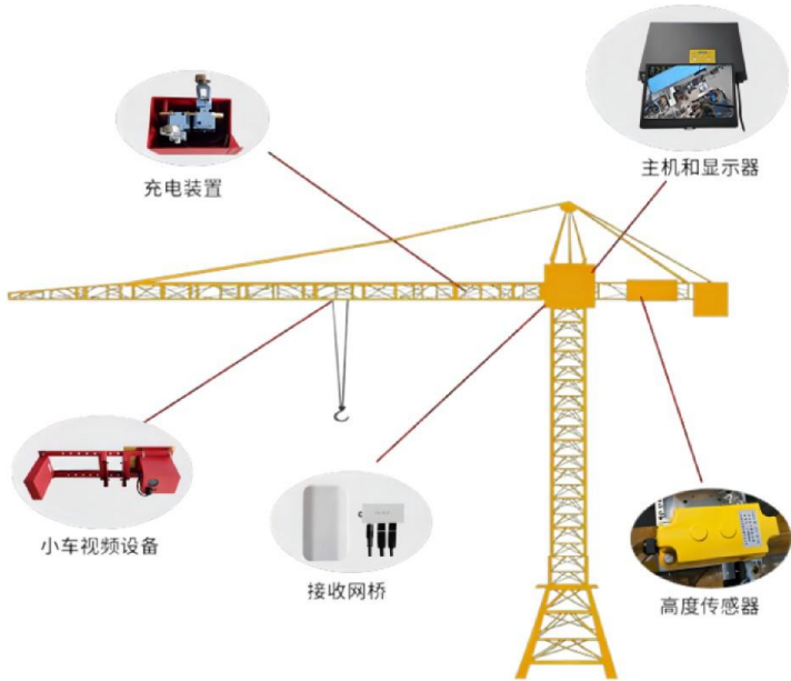
塔机吊钩可视化系统架构
