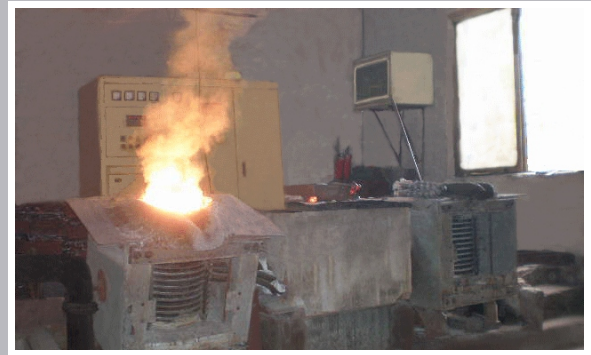
中频炉 IF furnace smelting
