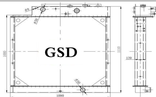
挖机全铝水箱 外形: 1110×1090×225 水口: \phi 50
