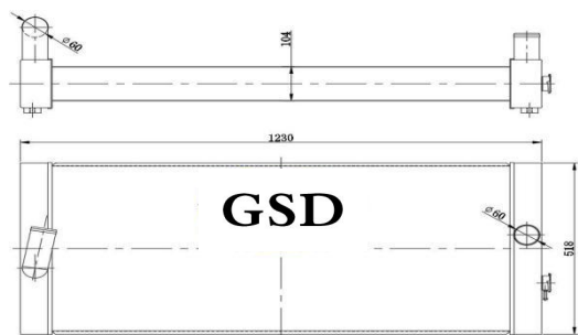
挖机全铝水箱 外形: 1235×520×145 水口: \phi 60
