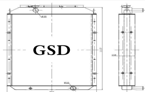
挖机全铝水箱 外形: 1115×860×158 水口: \phi 50
