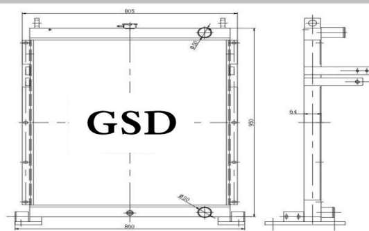
挖机全铝水箱 外形: 950×805×74 水口: \phi 50
