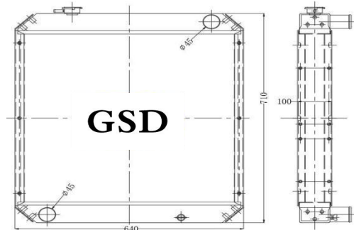
挖机全铝水箱 外形: 710×640×100 水口: \phi 45
