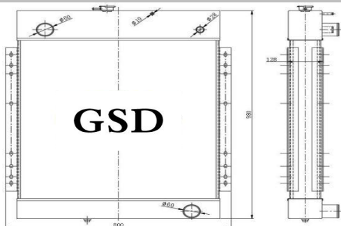
挖机全铝水箱 外形: 980×800×125 水口: \phi 60
