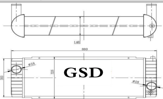
挖机全铝水箱 外形: 880×830×180 水口: \phi 58
