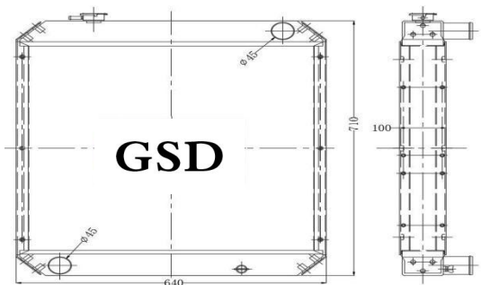
挖机全铝水箱 外形: 710×640×100 水口: \phi 45
