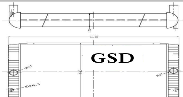
挖机全铝水箱 外形: 1180×630×140 水口: \phi 58
