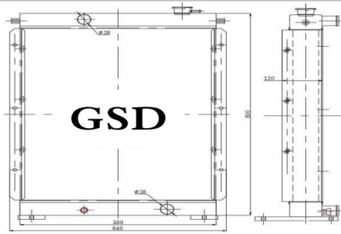
挖机全铝水箱 外形: 800×640×120 水口: Φ38
