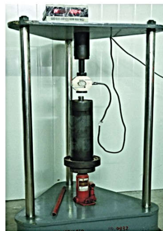
托辊轴向载荷试验台
