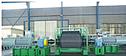
▲ 机头传动部 Transmission section
