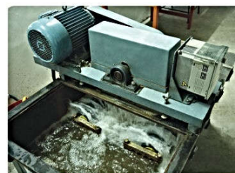
托辊浸水试验台
