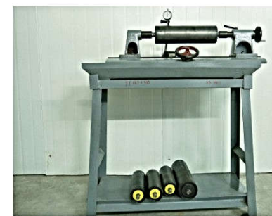
托辊径向圆跳动试验台
