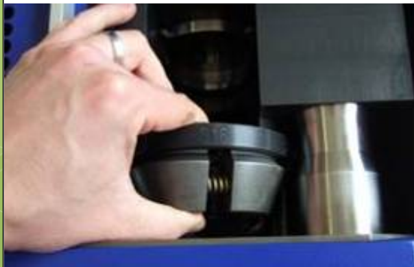
Clamping jaws (Changing without tools) 夹抓更换不需要工具
