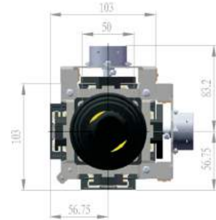
4触点模块+1副零位触点
