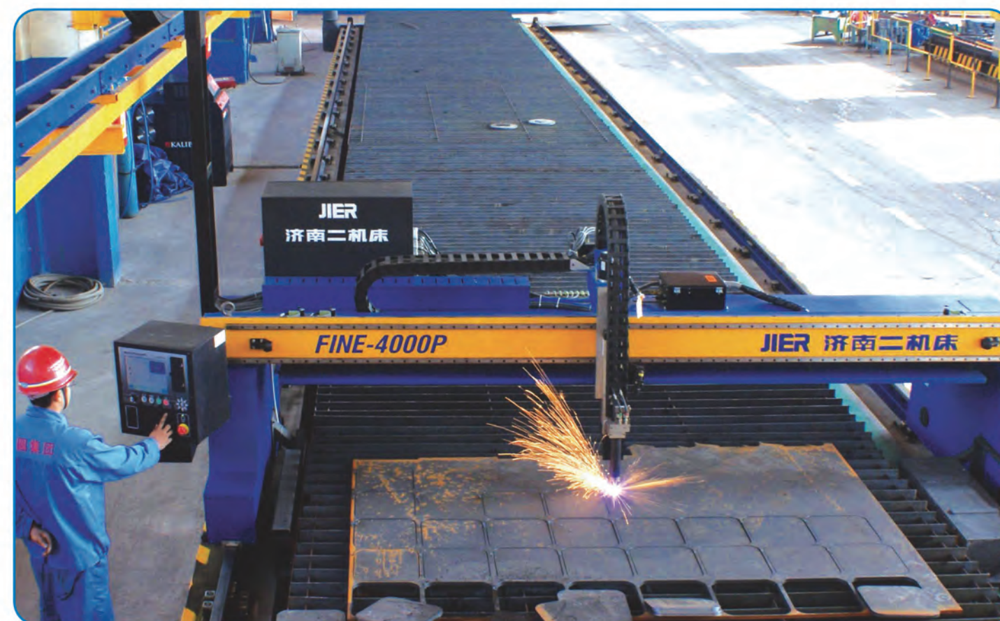
▲ 板材类先进下料工艺之数控精细等离子高速切割
