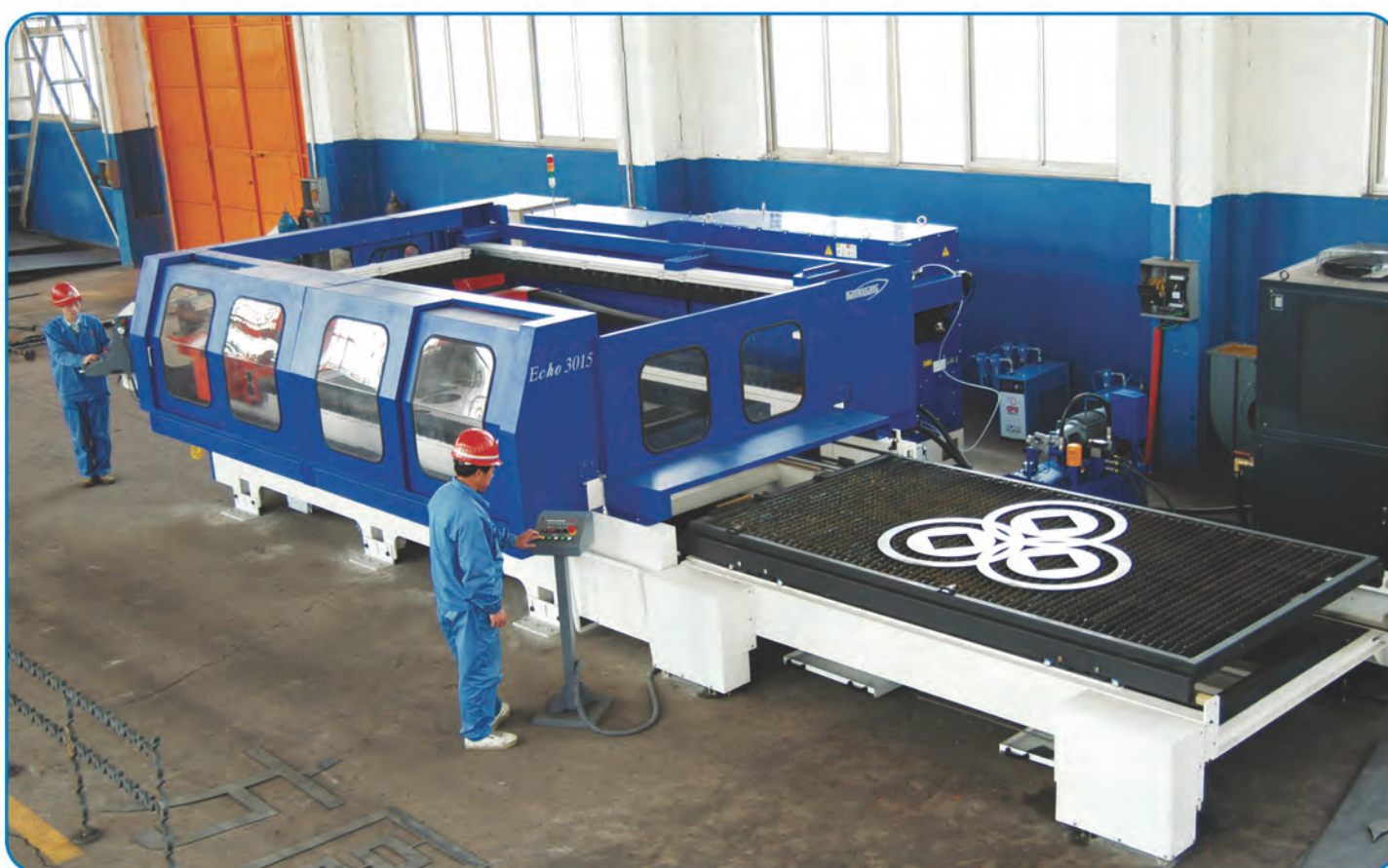
▲ 板材类先进下料工艺之激光切割
