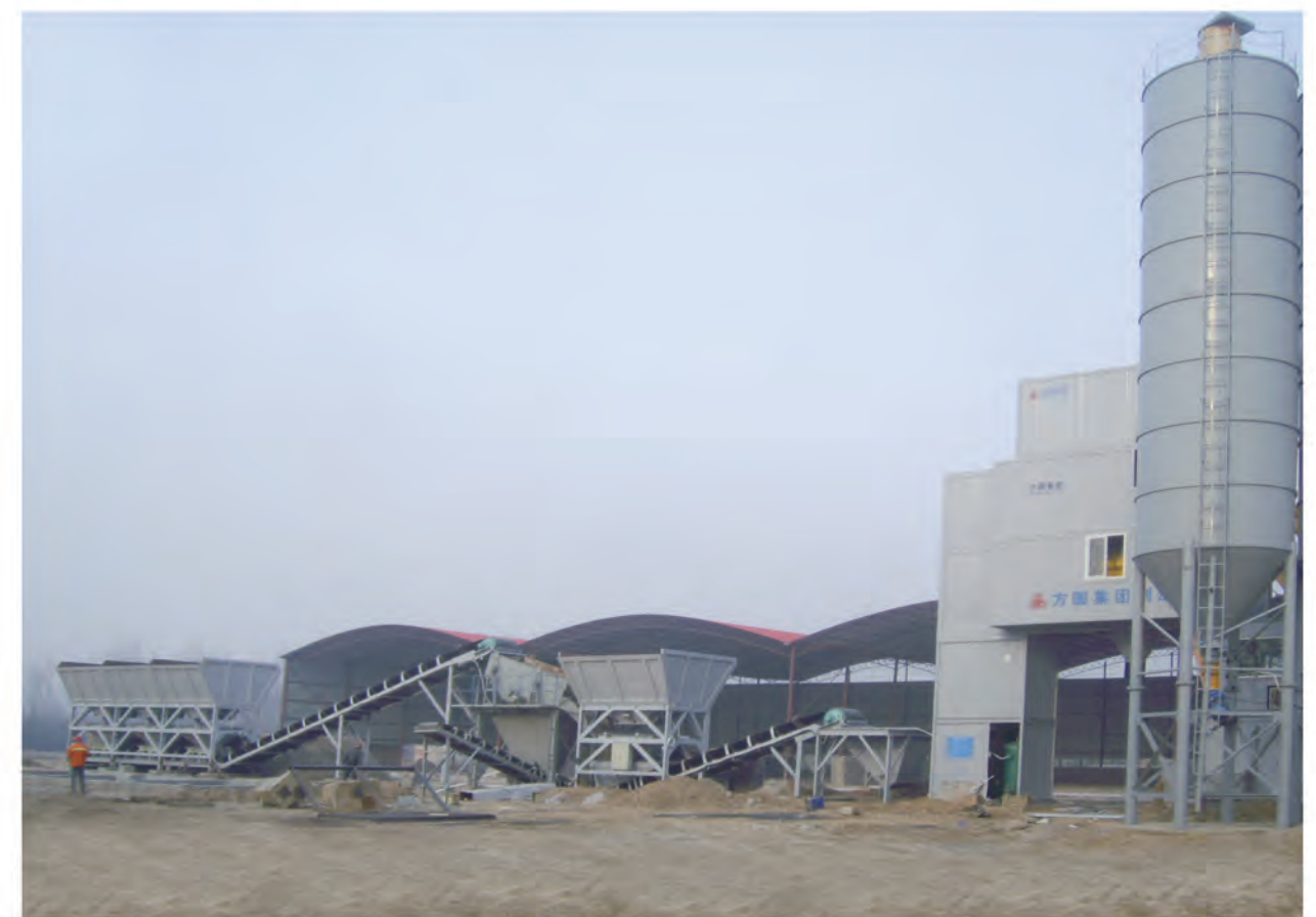
▲ 增加洗石机特殊设计搅拌站
