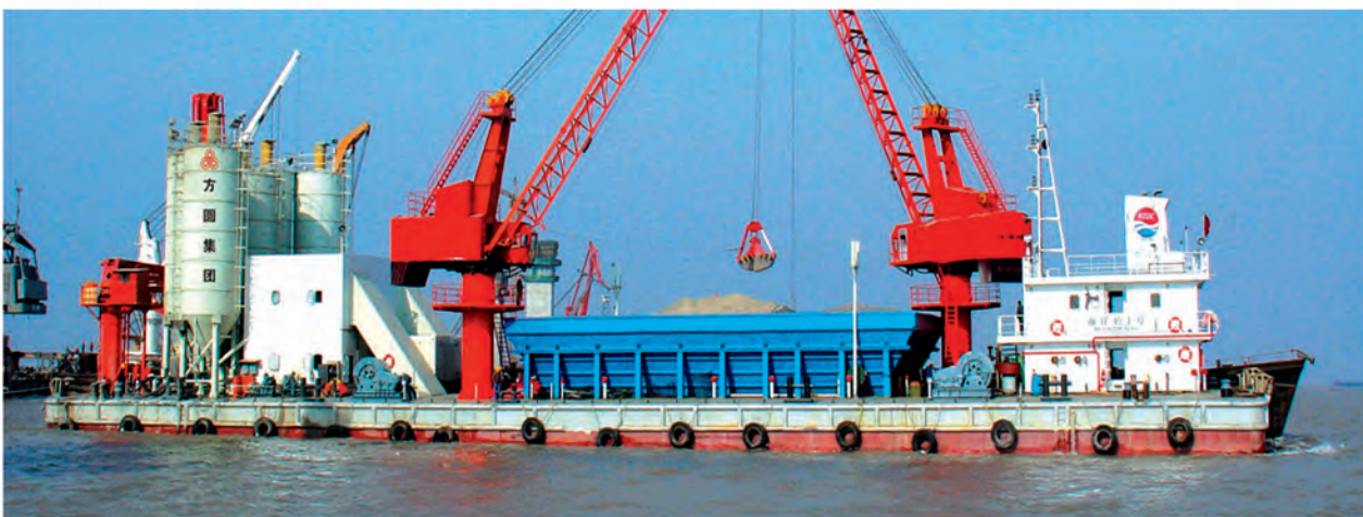
▲ 中铁大桥局船载特殊配料机
