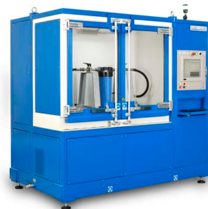
过滤器试验台
