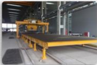
Fixed table Line 固定模台生产线
