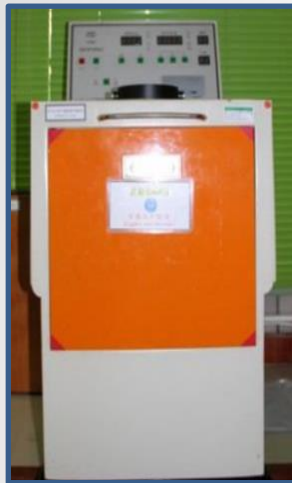
滤材透气度测试
