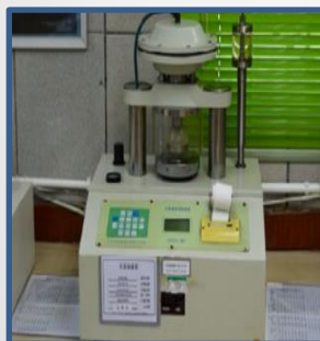
滤材耐破测试
