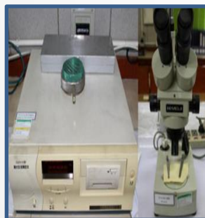
滤材最大孔径测试
