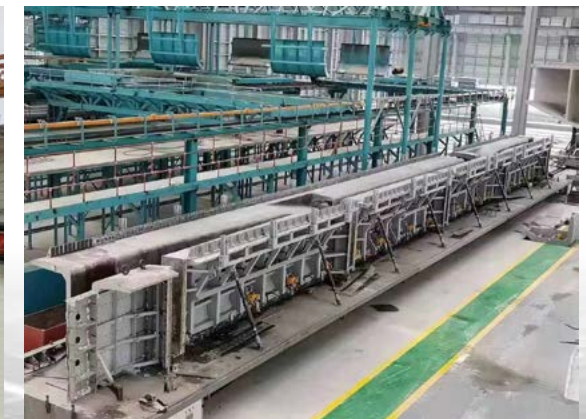
上海电气公路 T 梁模板智能生产线
