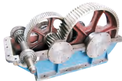
减速机内部结构
