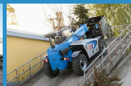
满载最大爬坡度试验（坡度45%）
