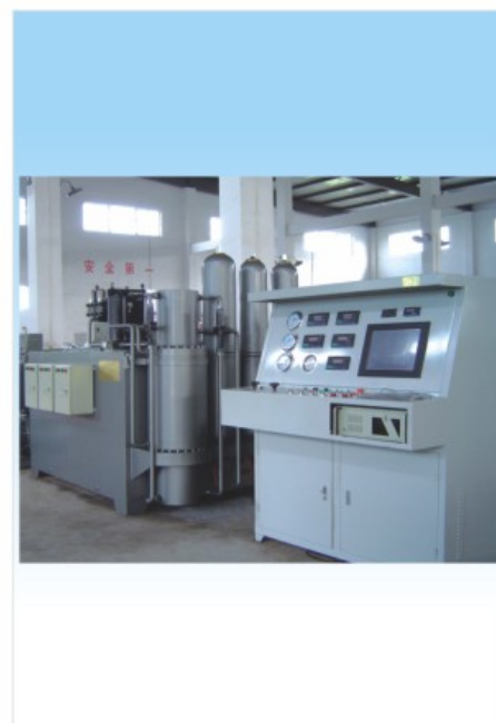
为浙江压力容器公司制造的国内 外先进的数控式压力容器 (气瓶) 疲劳试验机 Design for zhejiang pressure vessel company
