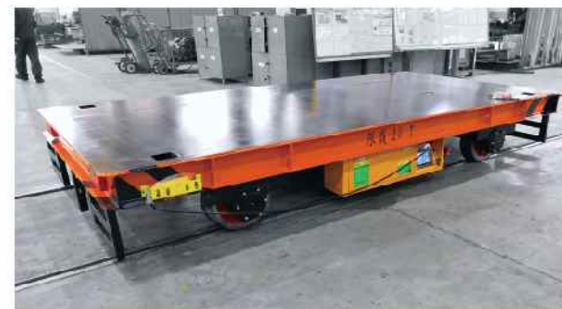
HSKPX 型蓄电池供电轨道平车
