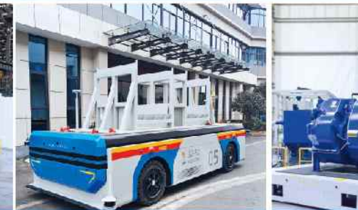
铜冶炼行业产品转运无轨平车
