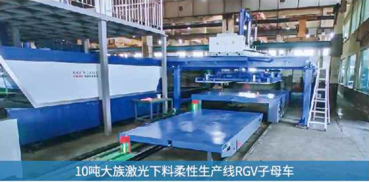
激光下料线摆渡接驳车RGV-20
