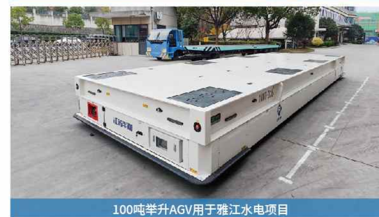
定制高精度特种重载AGV
