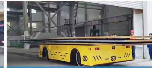
重型钢板运输无轨平车
