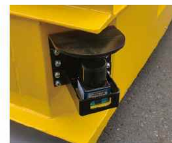
无死角感应式安全防护
