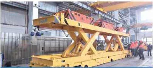
重载15吨剪叉升降平台无轨平车
