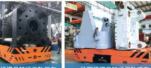
注塑机模具转运无轨平车
