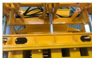
脱模系统 Demoulding system
