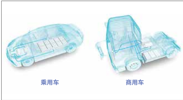
冷却配管 空气配管 氢气配管 水排放管
