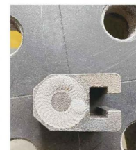
闸板激光熔覆
