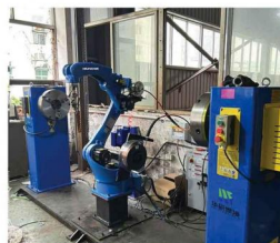
双工位八轴机器人自动焊
