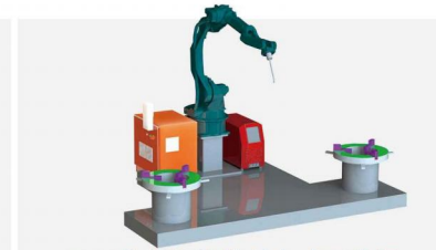
双工位外部旋转轴立式环缝焊
