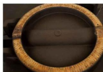
铸铁闸板堆焊铝青铜
