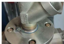
法兰氩弧焊加丝
