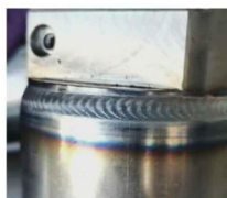
减震器氩焊脉冲加丝焊
