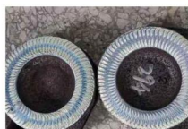
闸板堆焊司太立
