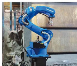
六轴关节机器人自动喷塑
