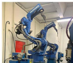
双工位六关节机器人汽车桥架自动焊
