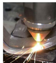
农业机械旋耕机刀头激光熔覆陶瓷
