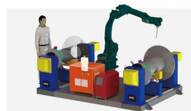
双工位外部旋转轴卧式自动焊
