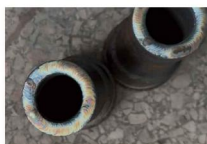
阀座圈堆焊司太立
