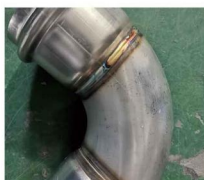
氩弧焊单面焊双面成型
