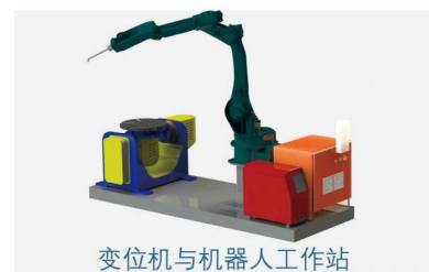
双工位外部旋转轴卧式自动焊
