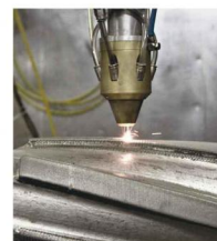
螺旋激光熔覆
