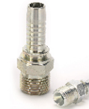
P12611 英管外螺纹60° 内锥面 BSP MALE 60° CONE SEAT
