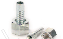
P20711-T 国标公制内螺纹74° 内锥面 GB METRIC FEMALE 74° CONE SEAT 参考REF.GB/T 9065.1
