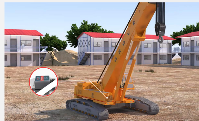
起重机、吊机角度测量
