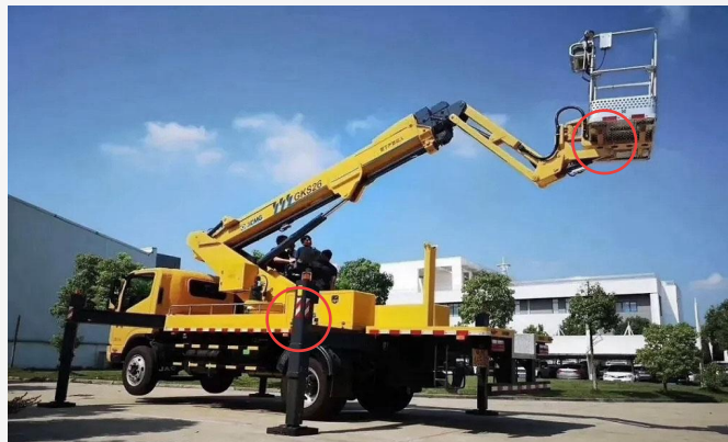
高空作业车调平，支臂、吊篮角度控制
