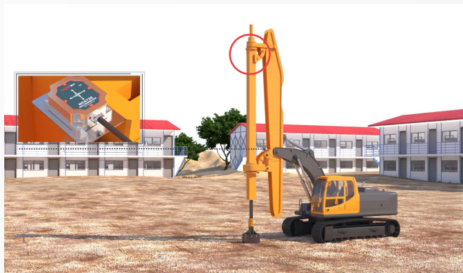
旋挖钻机垂直度测量
