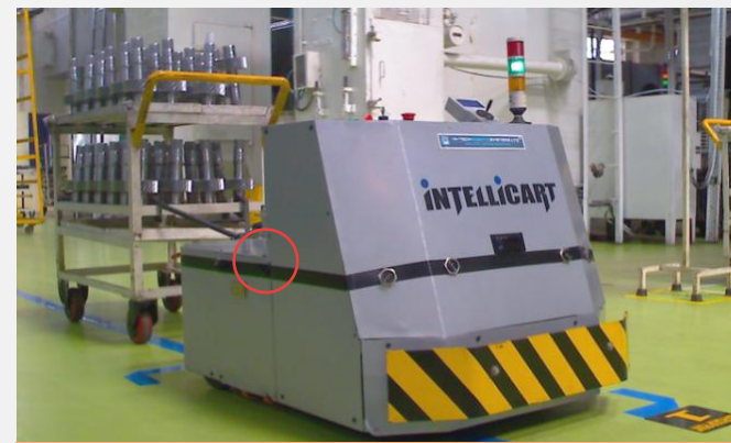
室内AGV车、分拣车方向引导
