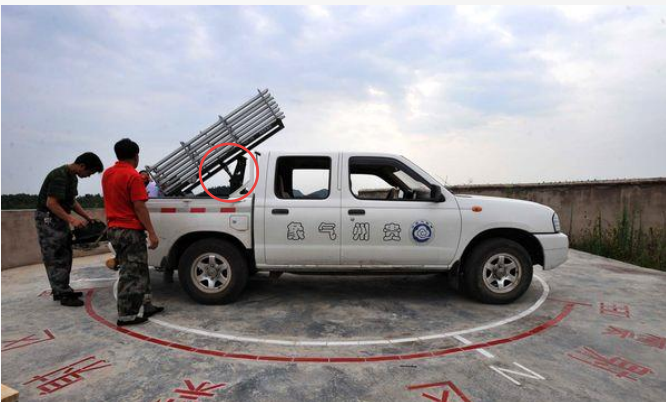
人工降雨高射炮&火箭炮方位、射角控制
