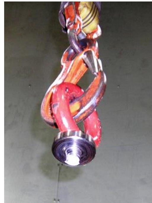
... 吊环螺丝：断裂 ...
