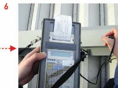
干燥后测定干膜厚度
