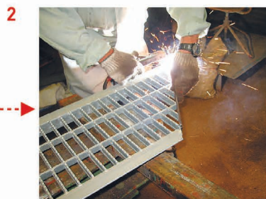
把去除氧化皮的钢条焊接在切割面上
