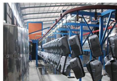
电泳涂装流水线
