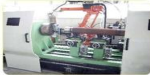
机器人系统焊接工作站 Robotic system welding workstation
