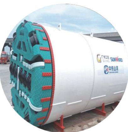
采用液压顶管技术,在非开挖敷设地下管道的机械设备中,具有减少施工扰动、避免不必要的拆迁等特点,主要用于煤气、热力、电力、给水、排水等地下管道的施工,被誉为城市管廊建设“神器”。
