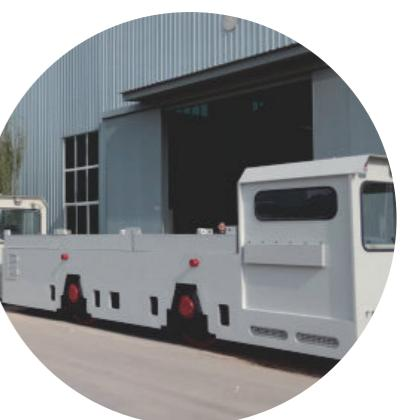
水平运输车主要应用在盾构/TBM等隧道掘进设备的配套施工运输中。利用牵引机车对渣土、浆料、管片、人员等进行运输,为隧道内外联络和物资交换提供便捷的服务。常用的设备包括机车、渣车、砂浆车、管片车、人员车、板车、混凝土搅拌罐车等。
