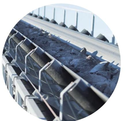
皮带机是专门用于隧道开挖出渣的连续性物料运输设备,主要和盾构机或硬岩TBM配套施工,可实现不停机掘进,是隧道施工机械化、成套化的关键设备,具有出渣速度快、施工效率高、操作维护简单等特点。
