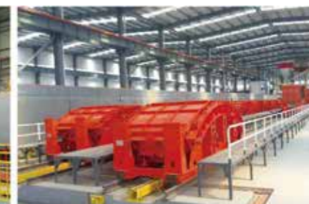
浙江建材集团 2+3 管片生产线 Zhejiang Construction Materials Group 2+3 Segment Carousel
