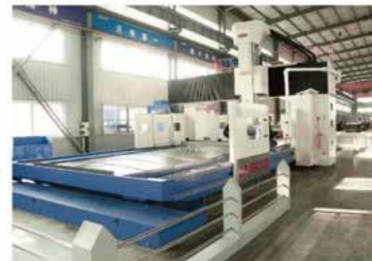
数控龙门加工中心 CNC gantry machining center
