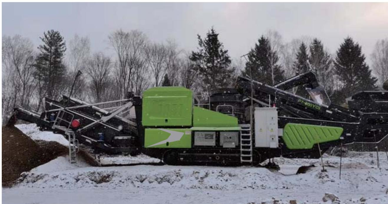
预筛分系统: 将部分合格骨料直接排入主皮带, 减少破碎机负载, 提高产量、降低能耗
