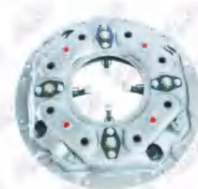
规格:430*248*456 杠杆式 窄/宽爪 车型:五十铃、日野、三菱、尼桑
