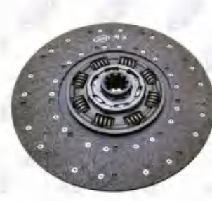
规格:430*10T*50.8/44.5 小八簧 车型:东风天龙、雷诺/金龙、宇通、斯堪尼亚...
