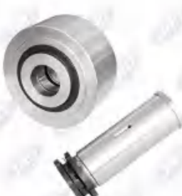
徐工九方托轮 (老款) Φ 230*110/131 轴 Φ 70 轴承 30314
