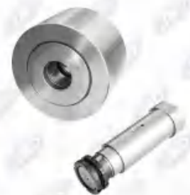
中联十五方托轮 Φ 240*150/159 轴 Φ 70 轴承 32314
