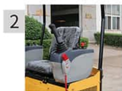
液压先导操作, 自带安全锁
