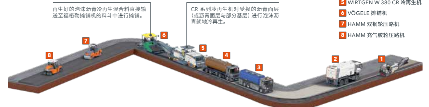
W 380 CR 进行拓宽式就地冷再生流程图
