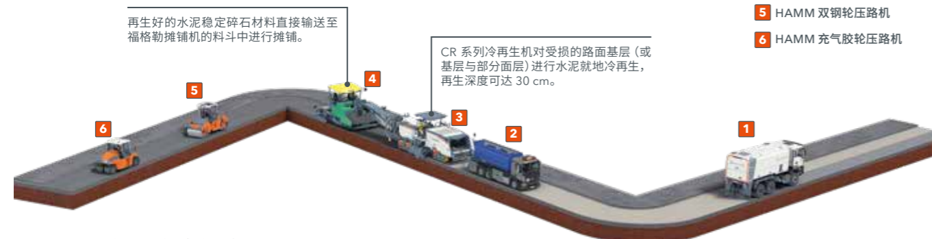
W 380 CR 进行水泥就地冷再生流程图
