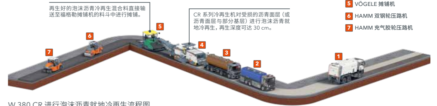
W 380 CR 进行泡沫沥青就地冷再生流程图
