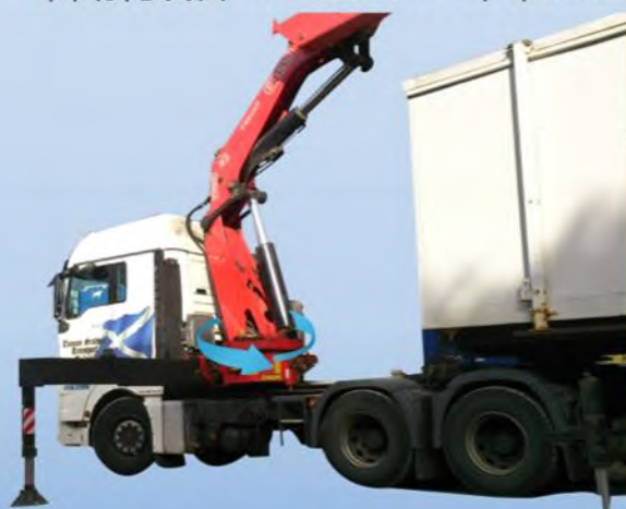
◆汽车吊 Truck crane
