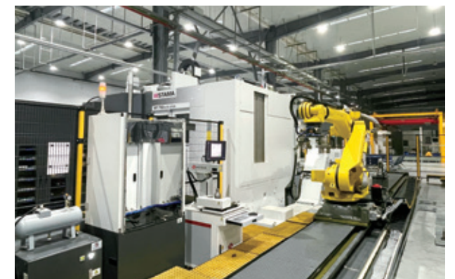
液压泵、马达缸体线
