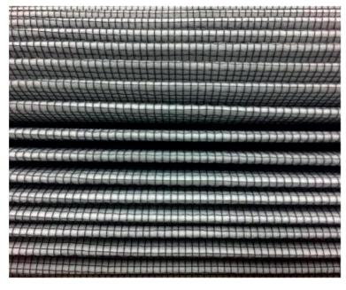
玻璃纤维介质具有均匀的孔隙结构,使其能够捕获和包含比纤维素更多的颗粒。它不容易受到结构操纵,并且不受脱落的影响,因此污垢会留在原地。因此,玻璃纤维过滤器被授予绝对评级,并被视为对一直在纤维素过滤器上运行的系统的升级。
