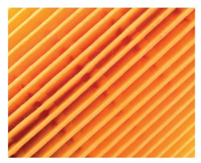
纤维素是一种广泛丰富的有机聚合物,主要来自 木浆和棉花,生产成本相对便宜。然而,它缺乏 均匀的孔隙结构使其具有标称额定值,这可以使 纤维素过滤器容易变质和脱落。虽然纤维素可以 捕获颗粒,但在保留颗粒方面效果较差,这在脱 落的同时会导致工业系统的损坏。
