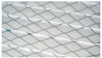
凝聚过滤器旨在在不同阶段将两种流体彼此分离,同时过滤掉颗粒物。在各种行业中都很常见,聚结过滤器有两种类型:液-液体过滤器和液-气体过滤器,聚结过滤器可以将散落在石油和燃料中的大液滴和乳化水结合在一起。然后,这些大水滴可以很容易地从油流或燃料流中去除。合成聚结介质现在取代了经过处理的纸张介质,以获得卓越的可靠性。
