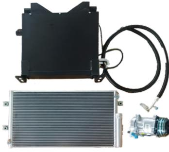
这个实例代表了一款适用于工程机械的冷暖空调模块,尤其是在诸如挖掘机驾驶舱、起重机驾驶舱和装载机车厢等场景中。它采用了具有防堵塞设计和防尘特性的冷凝器。电压为直流12V/24V。它配备了机械驱动的往复式压缩机,制冷量在3-4KW之间,制热量在4-5KW之间。
