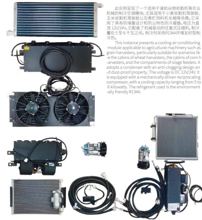
下面实例是两款适用于农业机械的拖拉机冷暖空调模块,冷凝器不易堵塞设计,防尘,电压:直流12V/24V; 机械驱动型往复式压缩机,制冷量3-4KW,制热量4-5KW。
