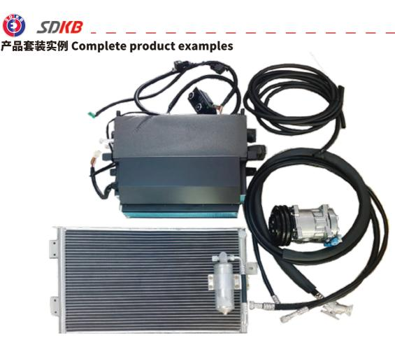
实例为一款适用于农业机械的拖拉机冷暖空调模块,冷凝器不易堵塞设计,防尘,电压:直流12V/24V; 机械驱动型往复式压缩机,制冷量3-4KW,制热量4-5KW。
