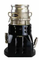
SM6600是一种大型的潜水泵,可以输送更大量的水,它可以将直径25mm以下的固体颗粒排出,扬程在6米高度时排水量能够达到600立方每小时。该泵主体材料为不锈钢制成,采用导叶式结构,结构轻巧,造型别致;泵的出口尺寸达到8 in. (200mm)
