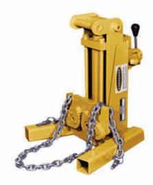
PP10拔桩机设计用来拆除带边法兰的标记桩和不规则形状的桩,桩最大宽度可达20cm,同时它具有203cm的行程以及4450kg拉拔力: PP10有两种方式解决拔桩的问题,对于带有法兰边的桩,使用夹爪挂在法兰上拉拔,对于不规则桩,需要使用一个铰链,同时为了防止链条打滑,将链条捆绑到需要拉拔的桩后将插销插入到拔桩机的凹槽内,PP10配有夹爪,链条和插销。
