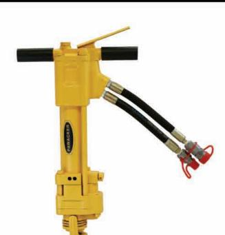
液压冲击锤钻能快速在水泥混凝土、岩石等硬质介质上钻孔。 广泛用于自来水、燃气等探漏钻孔,便于快速地找到漏点。 钻孔直径最大到50mm,深度达760mm。
