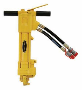
SK47主要用于爆破,煤气探漏以及销钉等钻孔。最大孔径可达2in.,最大钻深可达3m。工具采用气清渣,并随工具停止后自动关闭气流。SK47轻巧且易操作,适合于频繁移动的工作现场。其性能是:带有羽状开关,易于起动,可调转速(0-300rpm),配有尾鞭和快速接头。
