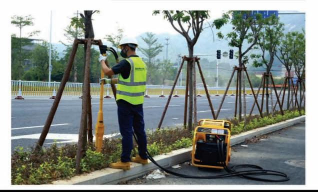
液压挖土钻主要用于安装标杆和规模植树时的快速挖坑,可以让工人长时 间高效、舒适的工作。直接驱动的液压马达功率强劲,功效高。
