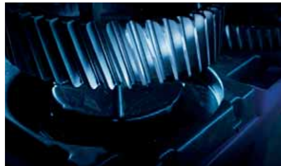
➤ Ingranaggio rettificato diam. max. 500 mm. Ground gear max. diam. 500 mm.
