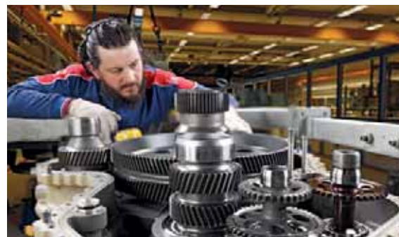
➤ Ingranaggi di una trasmissione per elicottero. Gears of a helicopter transmission.
