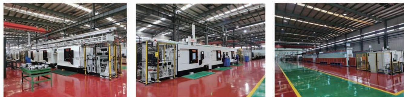
支重轮自动加工线 BOTTOM ROLLER AUTOMATIC MACHINING LINE 托链轮自动加工线 TOP ROLLER AUTOMATIC MACHINING LINE 整体通过式冷火线 HEAT TREATMENT AUTOMATIC MACHINING LINE
