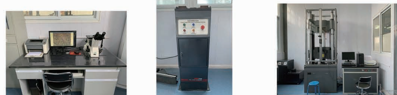
金相显微镜 METALLOGRAPHIC MICROSCOPE 缺口制样机 NOTCH PROTOTYPE 万能试验机 UNIVERSAL TESTING MACHINE
